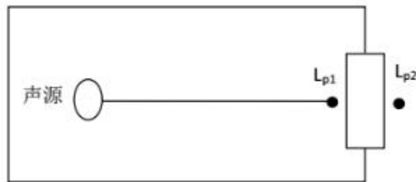
图 6.4-1 室内声源等效为室外声源示意图
