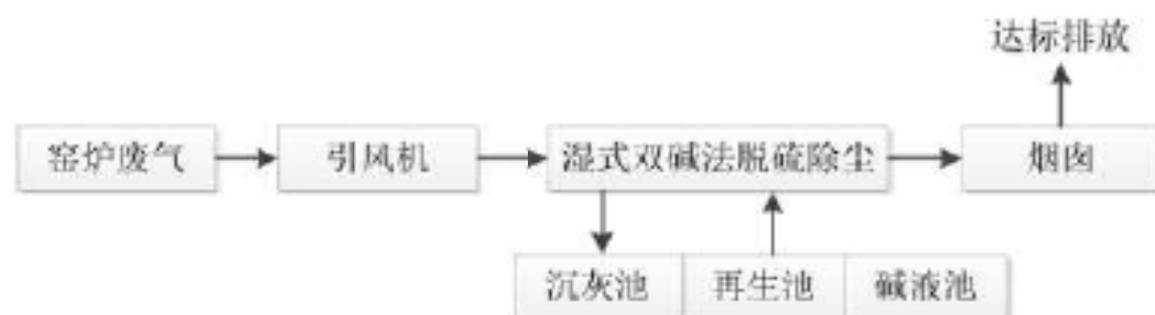
图2-5 窑炉废气处理工艺流程图
